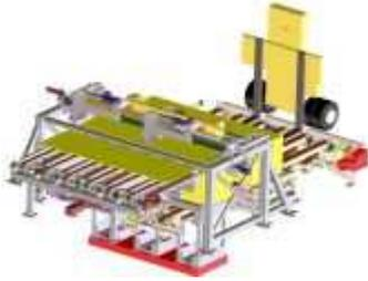
**Förderanlage für die Gipsplattenproduktion**
