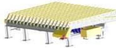
**Rollenförderer mit Drehhubgerät**
