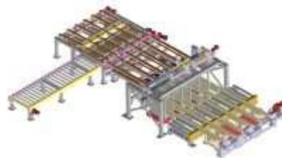
**Förderanlage für die Gipsplattenproduktion**
